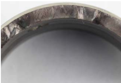
图 9 宏观断口形貌 Fig. 9 Macroscopic fracture morphology
