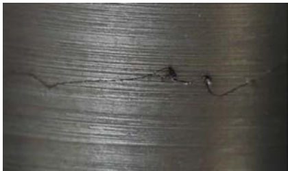
图 7 桨轴内圆面周向裂纹示意图
